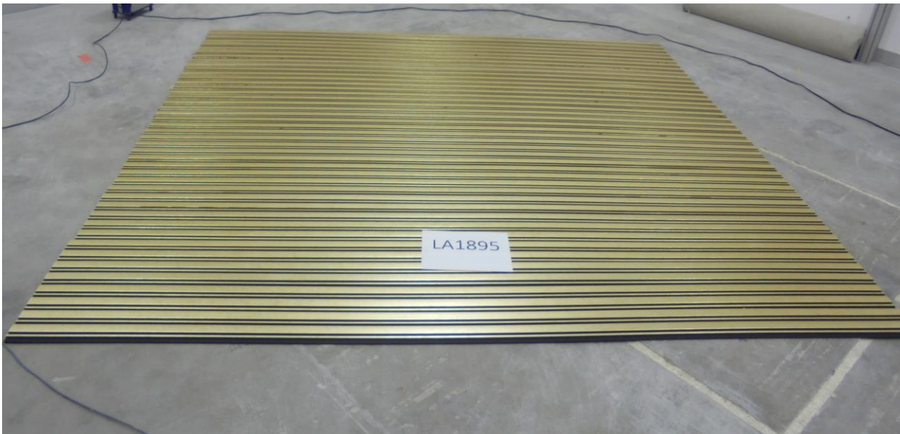
Rys. 1. Próbki LA1895 – Panele ścienne LAMELIO w komorze pogłosowej K3 w Laboratorium Badań Wibroakustycznych
